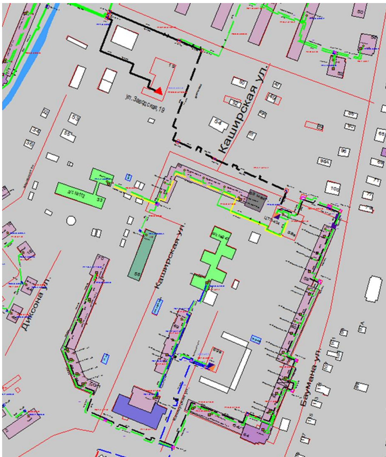
Рисунок 3...136 – Трассировка теплопровода от котельной ФГУП НПП «Полет» по ул. Заводская, д. 19 до конечного потребителя «ПТ-Кашир,70 э3»
